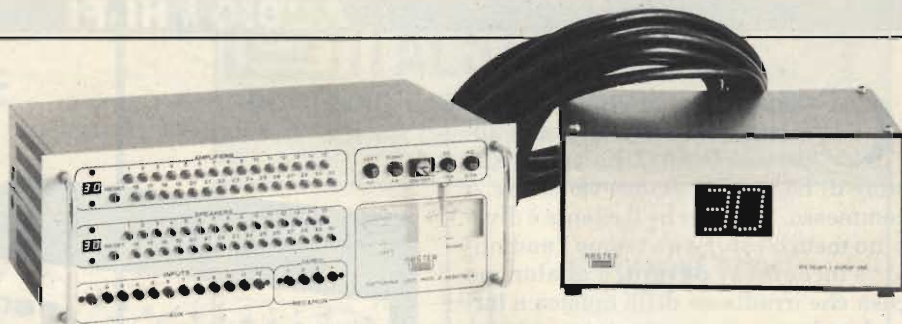
Fig. 3 - La centralina Z 3030/12-4 è adatta per sale di prova e dimostrazione molto fornite; sono disponibili trenta ingressi per amplificatore e trenta uscite per casse acustiche.
