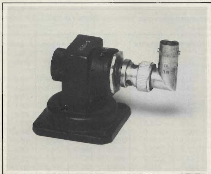
Le foto mostrano il trasmettitore a 10,3 GHz: a sinistra è visibile l'ingresso di modulazione, mentre a destra si nota la cavità risonante.
