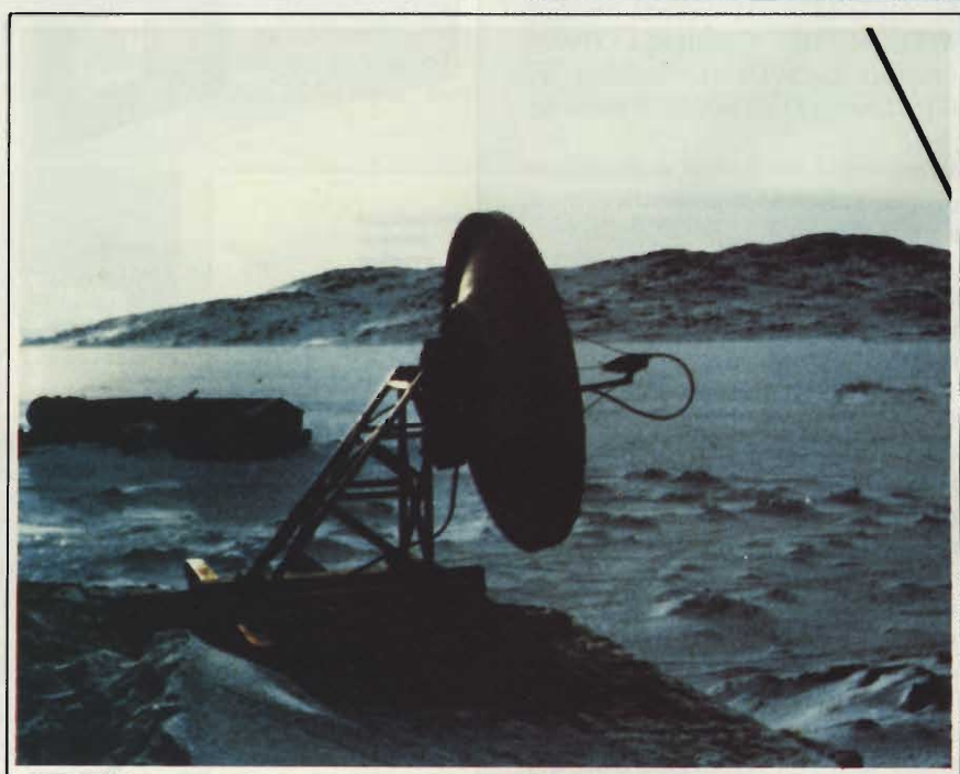
Fig. 1 - Antenna sperimentale usata per ricevere le trasmissioni TV dal satellite canadese "Hermes". la posizione pressochè orizzontale dell'antenna parabolica indica che il satellite si trova appena al di sopra della linea dell'orizzonte (angolo di elevazione basso).
